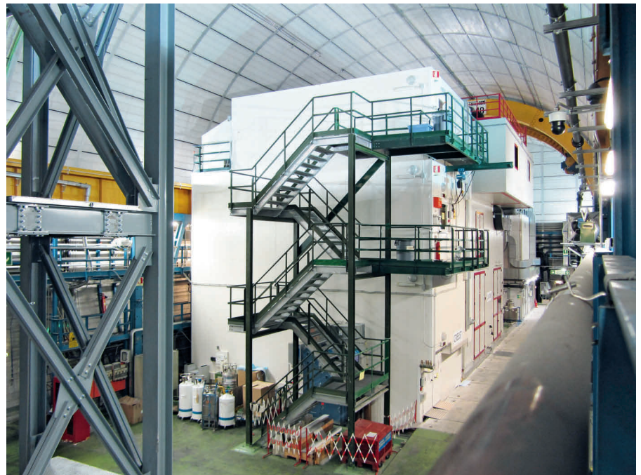
Tunnel der Erkenntnis: Das Experimentalmodul CRESST befindet sich im Gran-Sasso-Untergrundlabor, wo es 1400 Meter Fels der Abruzzien vor der kosmischen Strahlung schützen. Zusätzlich müssen die Forscher ihre empfindliche Apparatur noch vor weiteren Störeinwirkungen bewahren. Insbesondere radioaktive Spurenelemente im Fels verursachen unerwünschte Signale. Die gefährlichste Störquelle ist Radon-222, das bei dem natürlichen Zerfall von Uran und Thorium entsteht.
